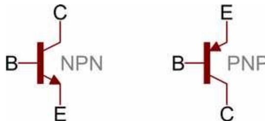
Les symboles de circuit pour les transistors NPN et PNP
